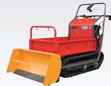
路面とブレードのスキ間を調整できるゴム製ローラー付
