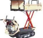
PX43L  | -1            | ¥594,000                                  | 最大積載量：400Kg<br>エンジン最大：4.2ps<br>リフトorダンプ<br>コンテナ4個並び荷箱            | 土・堆肥・穀物・果物・野菜などの運搬<br>木材・建築資材・土木用資材・農業資材<br>などの運搬。 <u>リフト機能で持ち上げや積<br/>み下ろし作業場面が多い農作業や野菜や<br/>穀物などの運搬や積み下ろしに最適。</u> 油<br>圧ダンプで堆肥や土の客土作業などで活<br>躍します。     |
